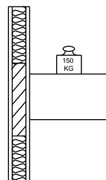
Por parte del propietario debe garantizarse un refuerzo de pared suficiente.
