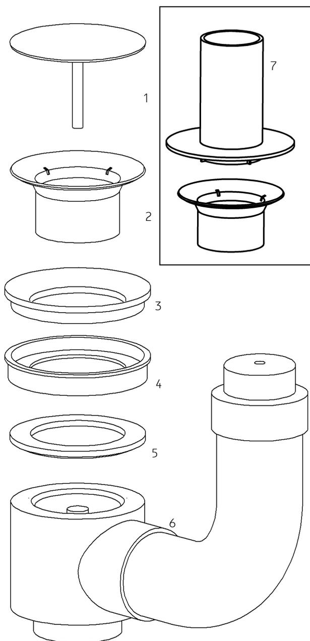
1. Ablaufkappe (1) von Ventileinsatz (2) abschrauben. Ventilschaft mit Dichtmittel eindichten und Ventileinsatz von oben durch das Ablaufloch führen.
